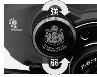
ノブを強く締めるとスプールの左右のガタが無くなりスプールにブレーキ力が発生します。ノブを弱く緩めるとスプールフリーが向上します。通常はスプールの左右のガタが無くなる程度に調整します。
