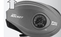
2.カムロックを外側に引きながらサイドプレートの前方を上側にスライドさせるとサイドプレートが外れます。
