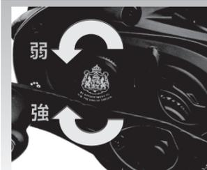
ノブを強く締めるとスピールの左右のガタが無くなりスピールにブレーキ力が発生します。ノブを弱く緩めるとスピールフリーが向上します。通常はスピールの左右のガタが無くなる程度に調整します。風が強く、キャスト時に糸が浮く時に締めこみ調整します。
