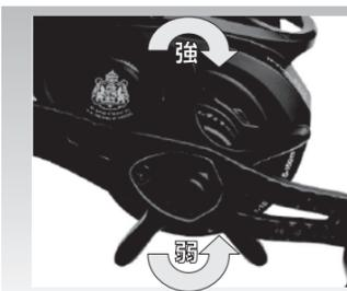
ドラッグとは、魚が強く引いたときにラインを切られないように魚の引く力に合せてラインをスムーズに送り出すシステムです。正確にドラッグを調整するには「バネばかり」を使用すると良いでしょう。スタードラッグを回転させてドラッグ力の調整を行います。
