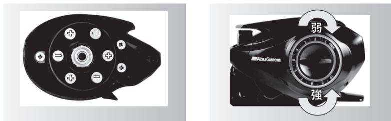
本機種のブレーキプレートには HS8 は 10 個、BF7 は 6 個のマグネットが装着されています。ブレーキが強い場合はお好みでマグネットの個数を調整することにより微調整が可能です。取り除く場合はドライバーの先などにマグネットをくっつけて外してください。マグネットは＋が図のように交互に配列するようにセットしてください。装着する際は隣の磁石と向きが同じようにならないよう注意してください。※マグネットを取り扱う際は右上の注意を読んでください。キャスト時にバックラッシュ防止のため、スプールにブレーキ力が必要な場合は、本ブレーキのダイヤルを強側 (MAX 側) に調整してください。ルアーのウエイトや、風の状況により強弱を調整してください。ピッチングするときはブレーキを弱く設定してください。※写真は右ハンドル仕様です。
