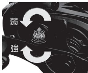
ノブを強く締めるとスプールの左右のガタが無くなりスプールにブレーキ力が発生します。ノブを弱く緩めるとスプールフリーが向上します。通常はスプールの左右のガタが無くなる程度に調整します。風が強く、キャスト時に糸が浮く時に締めこみ調整します。
