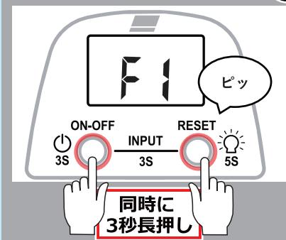
ON-OFFボタンとRESETボタンを同時に3秒押してください。出荷時F1が表示されます。
