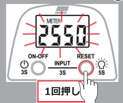
RESETボタンを1回押してください。前回セットした際のスプールの回転数が点滅して表示されます。(出荷時2550)
