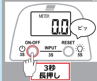
スプールに糸を固定した状態からON-OFFボタンを3秒押してカウンターの表示をONにしてください。
